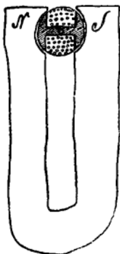
Bild 7: Handskizze eines Doppel-T-Ankers 1856 v. W. v. Siemens
